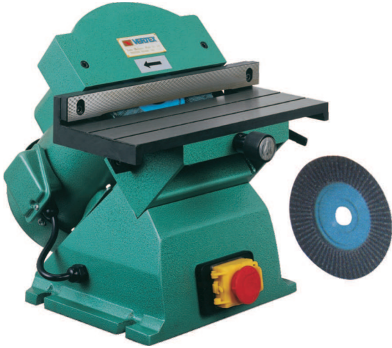
VCF-500S AKSESUAR : FLAP DİSK 165Øx22Ø
