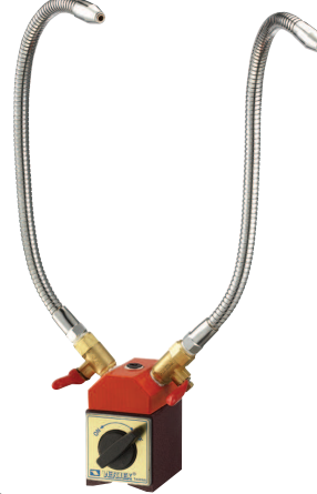
SİPARİŞ NO. VMH-64 MANYETİK AYAKLI METAL SULAMA HORTUMU (2 HORTUM)
